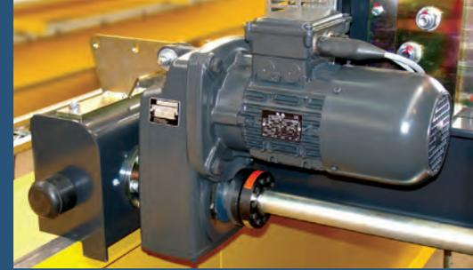
Motor del carro de servicio resistente y enfriado por aire.
